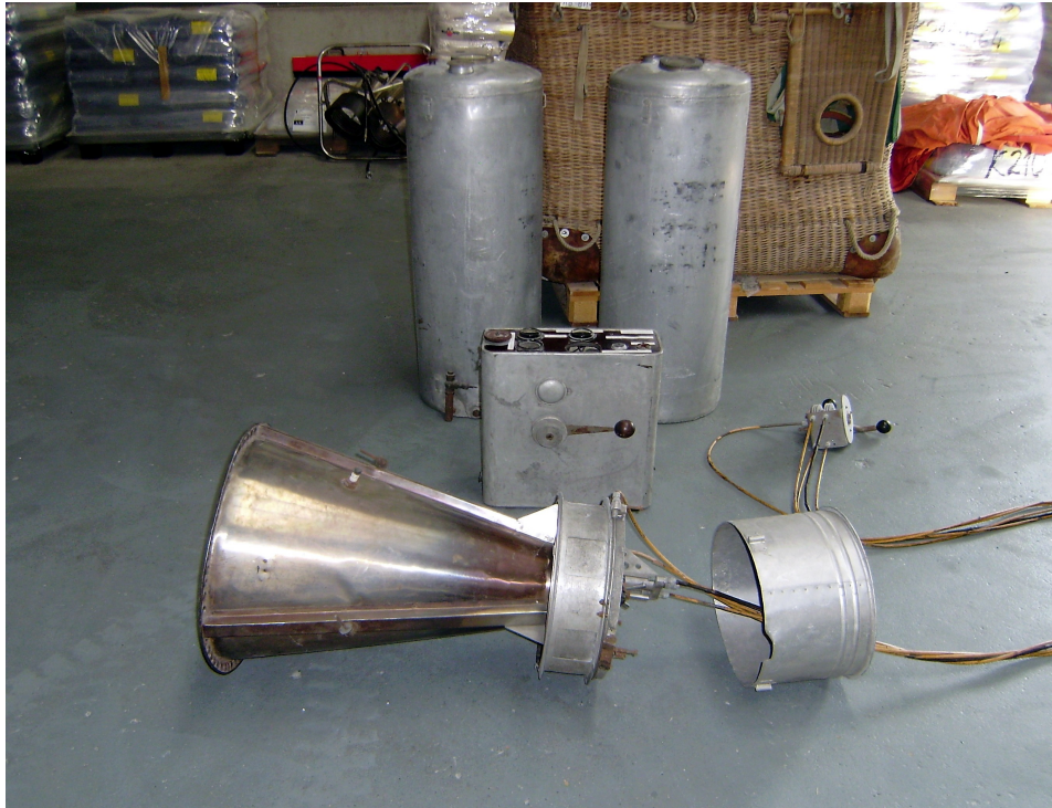
Brenner mit Schutzrohr, Instrumentenkoffer mit Oelpumpe, daneben Handschtaltung.
